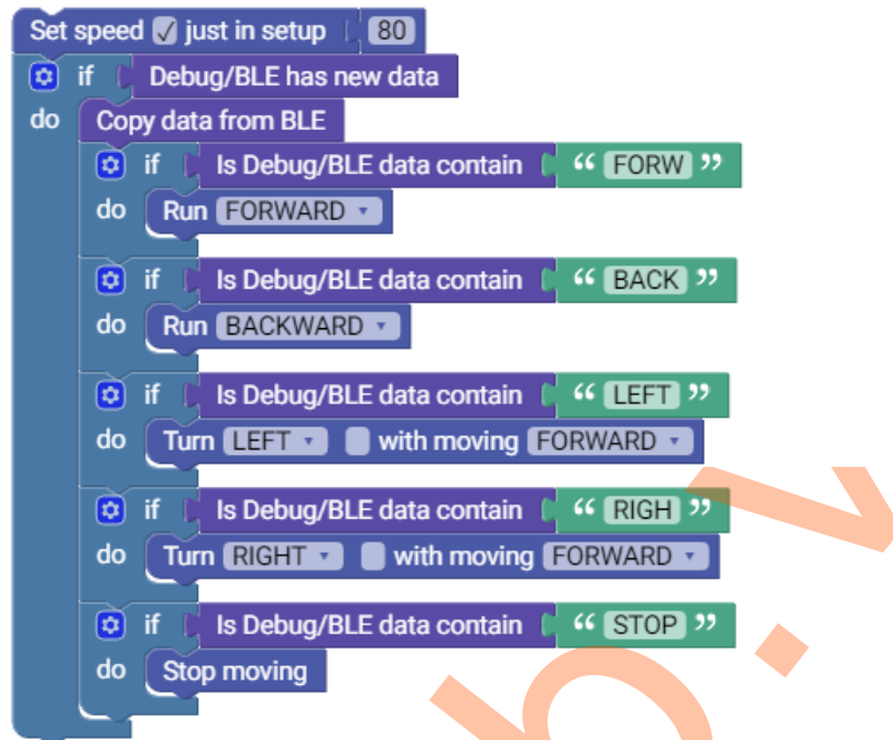
Hình 11.3: Chương trình điều khiển Robot sử dụng giao diện Rotation của Clover Master
